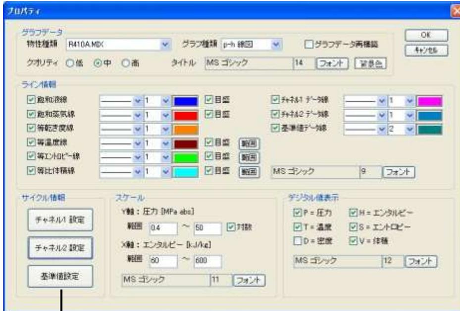
モリエル線図を表示する温度と圧力チャンネルを指定。
